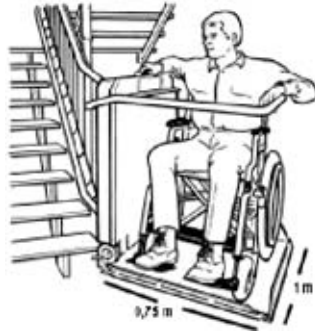
Fig. 43 – Plataforma elevatória para adulto em cadeira de rodas. Modificado de (147) .
